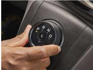
Neues 8 Gang Automatikgetriebe. Neuer Drehwähler auf der Mittelkonsole und Hebel am Lenkrad für die manuelle Auswahl
